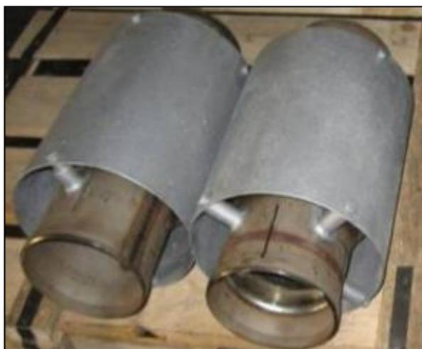
3.2.1.2 Сильфонный компенсатор типа ОПК – это осевой неразгруженный СК, типа ОПНР с легким защитным кожухом, установленным над сильфоном. Съемный кожух с помощью болтов закрепляется на бобышках, приваренных к одному из присоединительных патрубков. Второй конец
