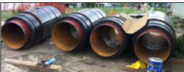
3.5.3.2 СКУ типа ППУ/ПЭ.1 – это сильфонные компенсационные устройства типа ППУ, патрубки которого теплоизолированы пенополиуретаном в защитной полиэтиленовой оболочке в соответствии с требованиями ГОСТ 30732-2006. Силовой защитный кожух сильфонных компенсационных устройств типа ППУ/ПЭ.1, применяемых при бесканальной прокладке, дополнительно гидроизолируется с помощью термоусаживающихся муфт.
