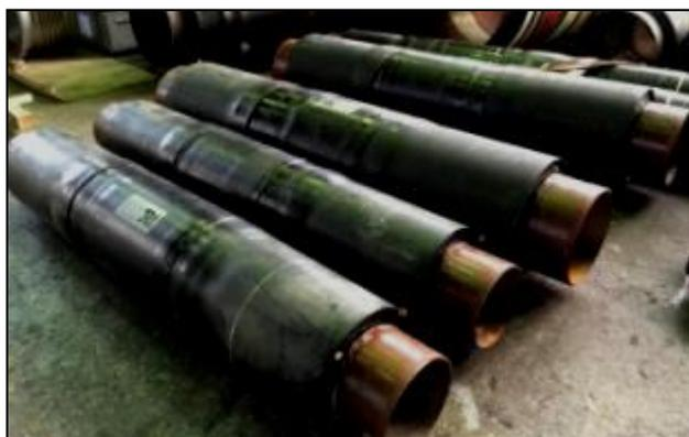
покрытие. Для снижения тепловых потерь внутри СКУ проложен теплоизоляционный материал, позволяющий также исключить возможность образования конденсата внутри СКУ.
