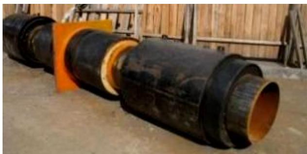
3.5.3.4 Теплогидроизолированные сильфонные компенсационные устройства типа ППУ/ОЦ по техническим условиям ИЯНШ.300260.033ТУ (приложение Е.5) предназначены для компенсации осевых температурных деформаций стальных трубопроводов тепловых сетей с промышленной теплоизоляцией из пенополиуретана с защитной оболочкой из тонколистовой оцинкованной стали.
