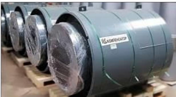
6.3.3.7 При складировании СК, СУ и ССК, поставленные без транспортировочных поддонов, должны укладываться на твердую, ровную поверхность без острых выступов. Допускается укладывать СУ на прокладках (ложементах) шириной не менее 10% их длины. При этом прогиб СК и СУ относительно продольной оси не допускается.
