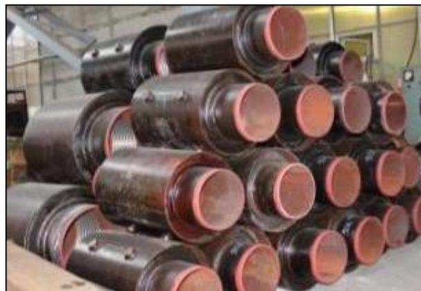
устройства при действии боковых нагрузок и делает его равнопрочным с основным трубопроводом, что позволяет применить компенсационное устройство без установки направляющих опор на трубопроводе. Технологические зазоры между внутренними направляющими опорами устройства и кожухом гарантируют его работоспособность при незначительной несоосности трубопровода во время монтажа.
