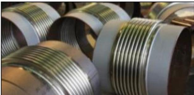
3.1.3 Сильфонный компенсатор типа ОПН (ОПНР) – это осевой неразгруженный СК, состоящий из сильфона и присоединительных патрубков под приварку к трубопроводу. Присоединительные патрубки изготавливаются из труб, разрешенных к применению в тепловых сетях, из материалов, соответствующих материалу трубопровода. У СК типа ОПНР увеличено по сравнению с СК типа ОПН значение компенсирующей способности за счет применения сильфона с измененными параметрами гофрированной части.
