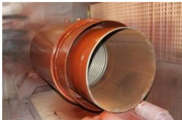
внутреннему диаметру соответствующая наружному диаметру полиэтиленовой или стальной оцинкованной оболочки пенополиуретановой теплоизоляции. Пространство между центрирующей гильзой и внутренней поверхностью силового защитного кожуха заполнено сальниковой набивкой для внешней гидроизоляции пространства между сиффоном и кожухом.
